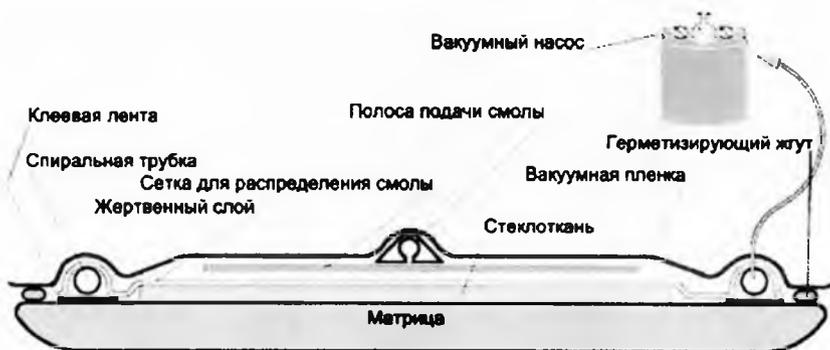
Рис. 5.5. Метод вакуумной инфузии
